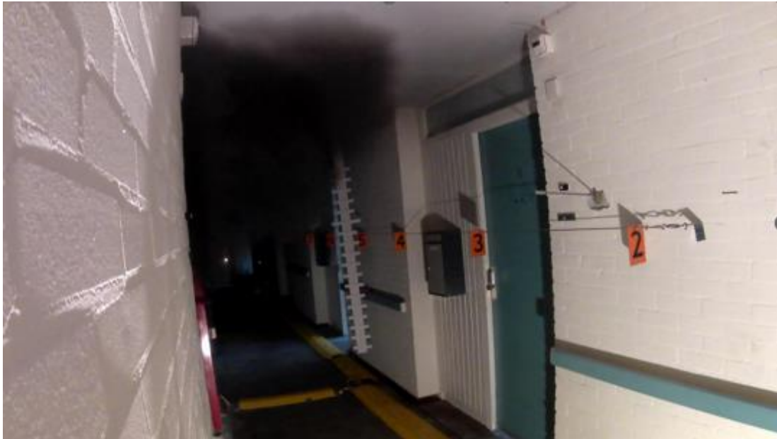
Figuur 1.1 Rookverspreiding in een gang na het openen van een voordeur van een woning waar een bank in brand staat. De beelden zijn gemaakt tijdens praktijkexperimenten die de rookverspreiding inzichtelijk maken.
